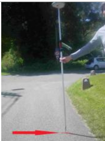
Laisse de crue sur la chaussée.
