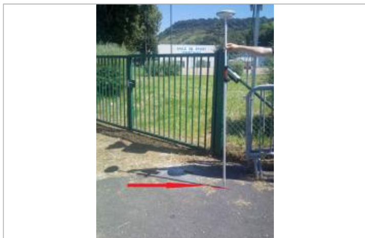
Laisse de crue sur la chaussée.
