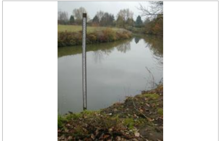
échelle de crues
