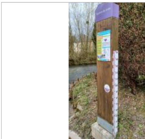
Cours d'eau : Saône. Macaron PHEC indiquant le niveau de la crue de décembre 1999 à 93 cm/ échelle limnimétrique.
