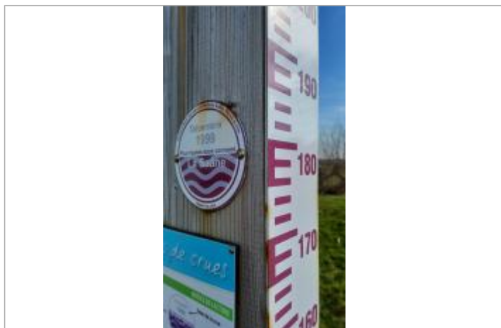
Macaron à 179 cm/échelle limnimétrique du totem.
