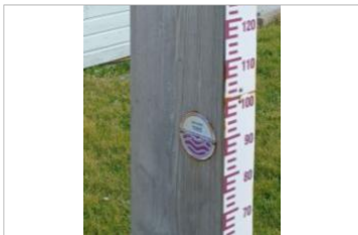
Macaron à 88 cm/échelle limnimétrique du totem.
