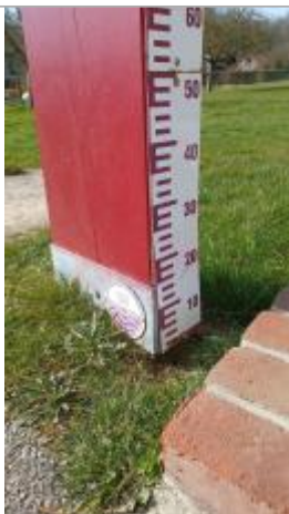
Macaron à 6 Cm/échelle limnimétrique du totem
