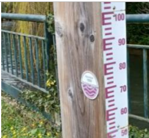
Cours d'eau : Saône. Macaron PHEC indiquant le niveau de la crue de Janvier 1995 à 14 cm/échelle limnimétrique.
