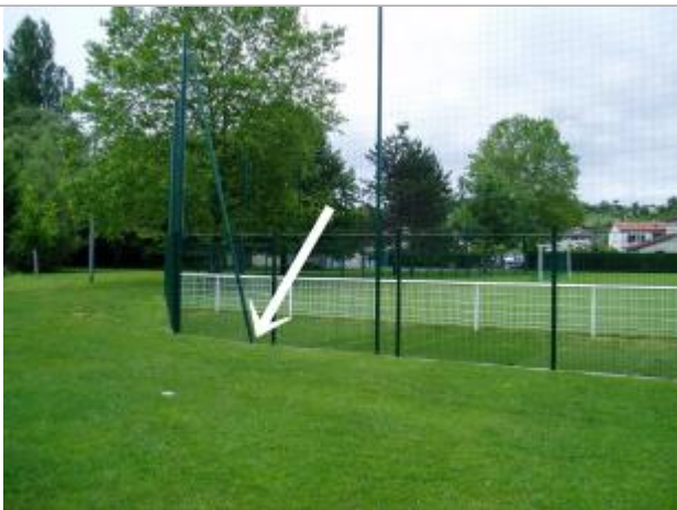
Vue vers l'aval. Sur des poteaux du grillage la crue a déposé une trace de boue.
