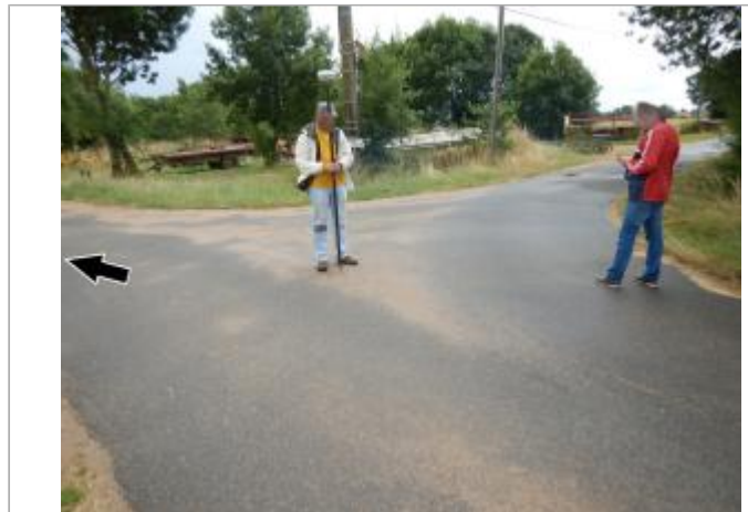
Emplacement du site (vers la flèche noire) et point GPS pour le nivellement du repère de la crue de juin 2016
