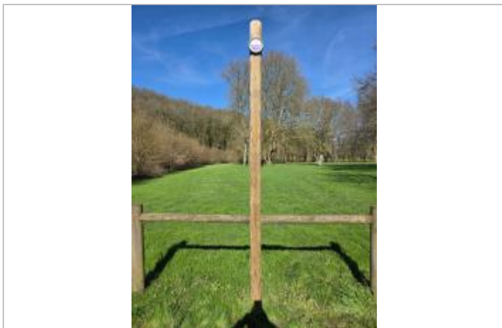
Repère installé sur un poteau à l'aire du Pointée
