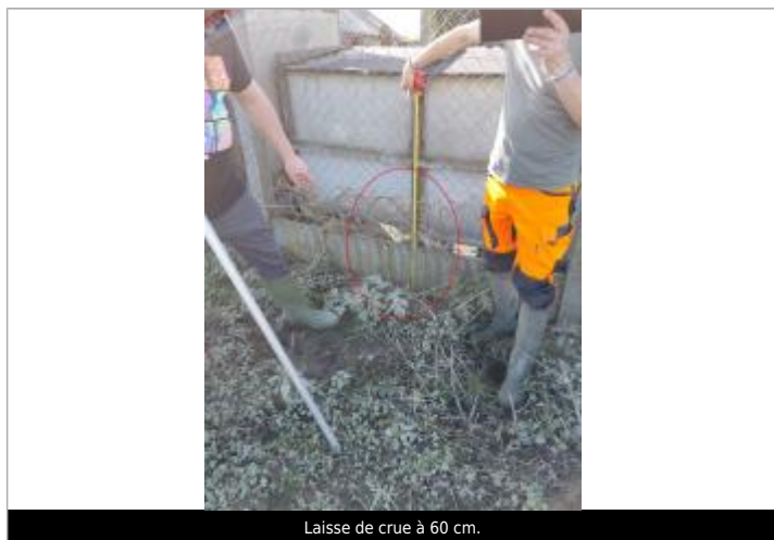
Laisse de crue à 60 cm.
