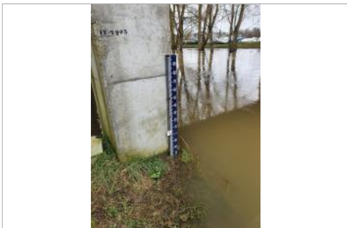
Echelle de mesure avec trace laissée par l'eau
