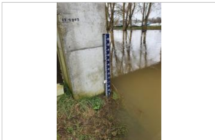
Echelle de mesure avec trace laissée par l'eau
