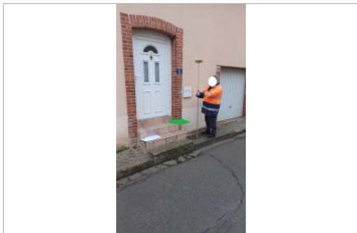
Laisse de crue à 35 cm/sol.
