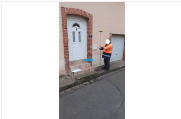
laisse de crue à 45 cm/sol.
