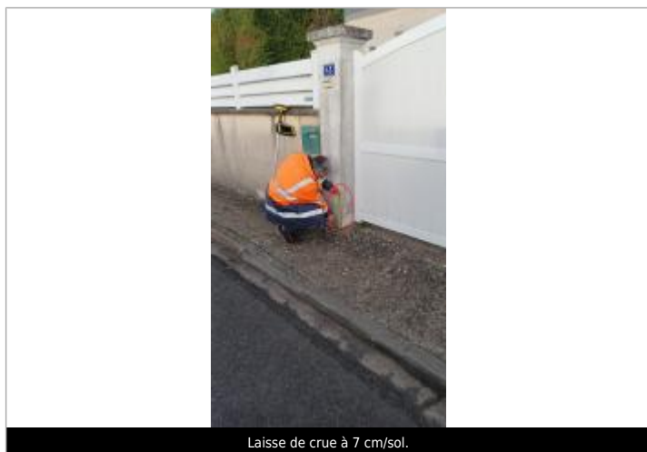
Laisse de crue à 7 cm/sol.
