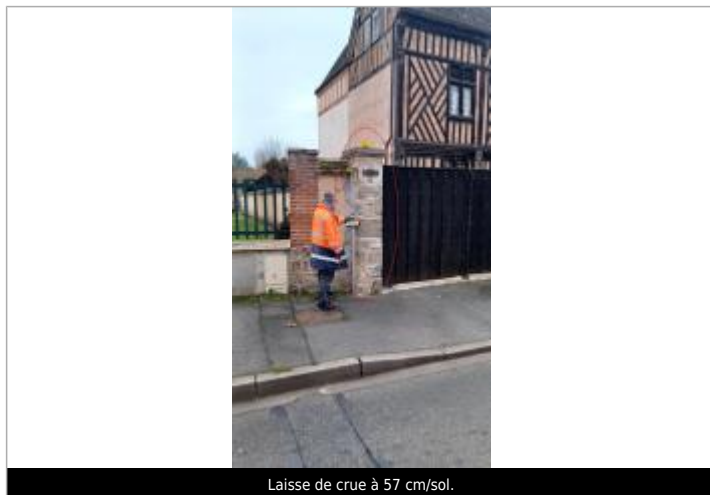
Laisse de crue à 57 cm/sol.
