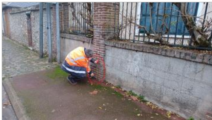
Laisse de crue à 4 cm/sol.
