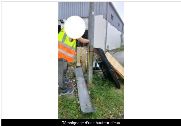
Témoignage d'une hauteur d'eau
