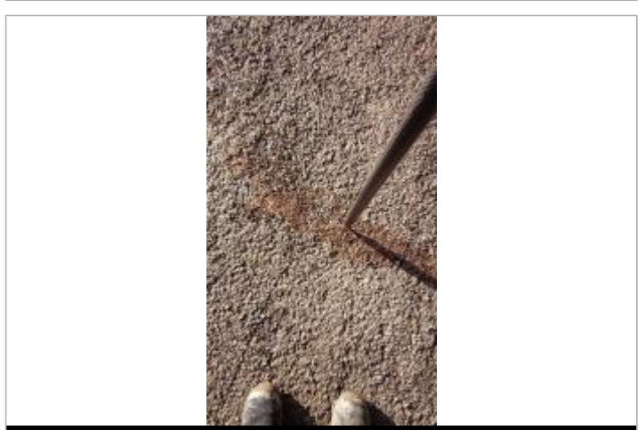
Relevé de la laisse d'inondation sur le chemin de halage le 05/02/2025 - photo SPC MLA
