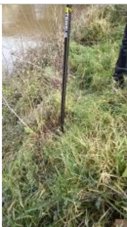
Relevé de la laisse d'inondation sur la berge du canal
