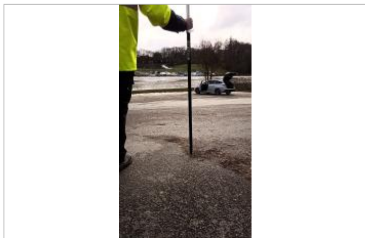
Relevé de la laisse d'inondation sur le parking
