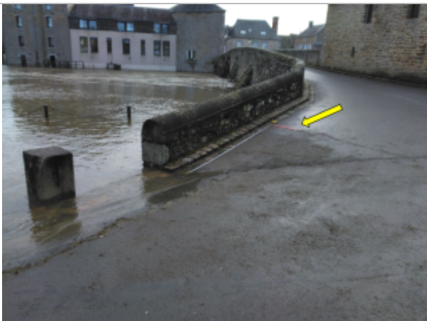
LC dépôt de végétation à 3,35m du bout du trottoir, longitudinalement.
