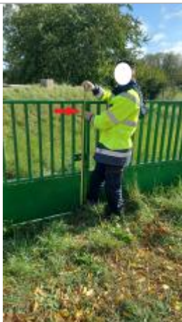
Laisse de crue à 127 cm/sol.
