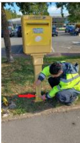
Laisse de crue à 9 cm/sol.
