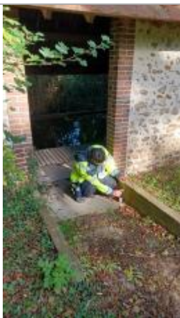
Laisse de crue à -10 cm/haut du muret.
