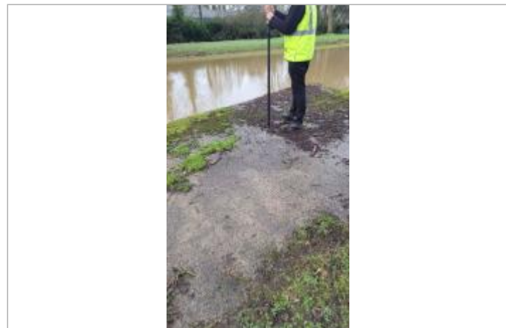
Relevé de la laisse d'inondation sur le chemin de halage en amont de l'écluse de Haut-Chalet
