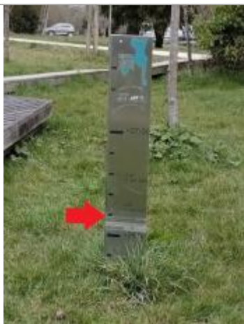
Totems des repères de crues (photo Rennes Métropole)
