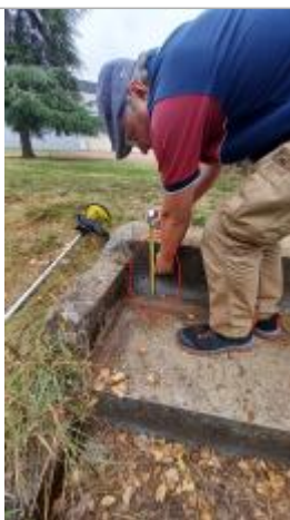
Laisse de crue à 14 cm/sol.
