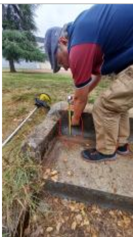
Laisse de crue à 14 cm/sol.
