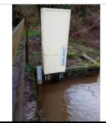
Echelle limnimétrique du Nançon à Lécousse\_Laignelet
