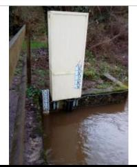
Echelle limnimétrique du Nançon à Lécousse\_Laignelet
