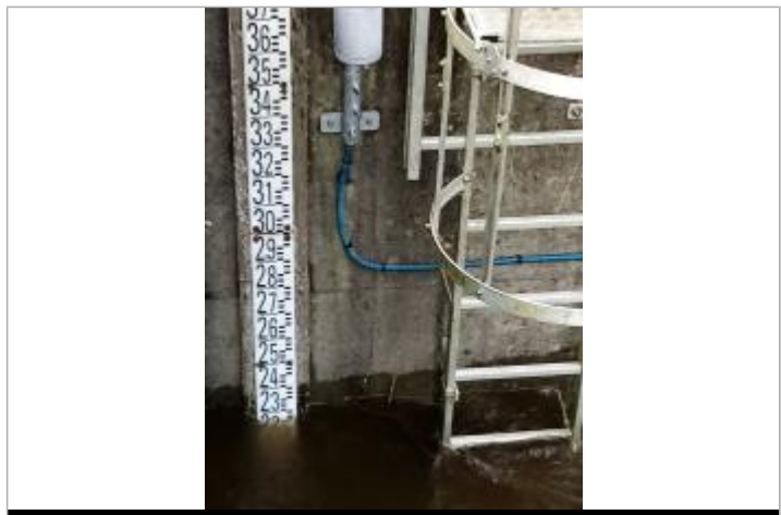
Echelle limnimétrique de la station de la Claie à Bohal - Saint-Marcel
