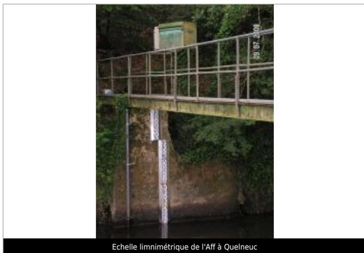
Echelle limnimétrique de l'Aff à Quelneuc
