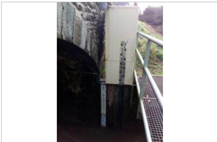
Echelle limnimétrique du Canut sud à Saint-Just
