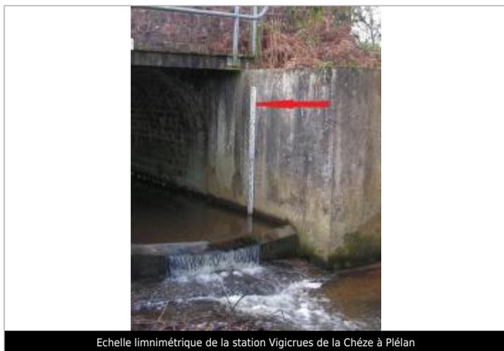
Echelle limnimétrique de la station Vigicruces de la Chèze à Plélan
