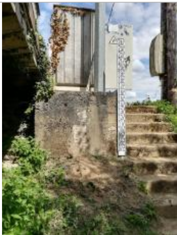
Echelle limnimétrique de la station Vigicrues à Amanlis
