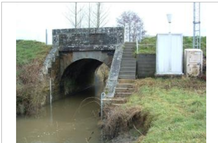
Station limnimétrique de la Cantache à Taillis (coté échelle)
