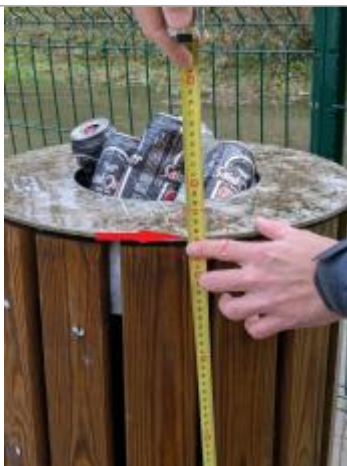
Laisse de crue à 64.5 cm/haut de la poubelle.
