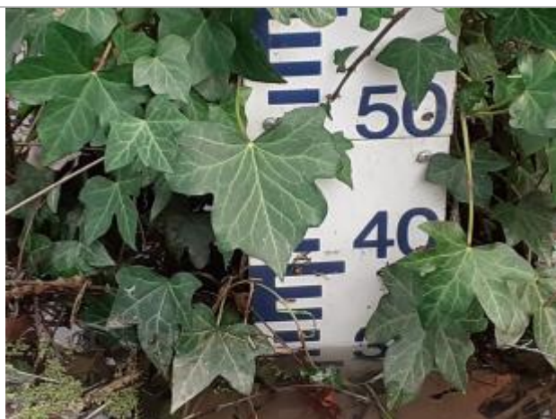
Laisse de crue à 0,41 m en lecture sur l'échelle de crue - photo Caen la mer
