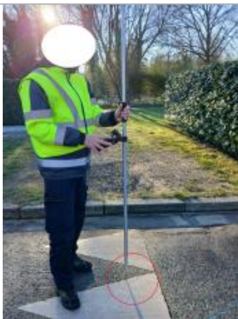
Laisse de crue au sol.
