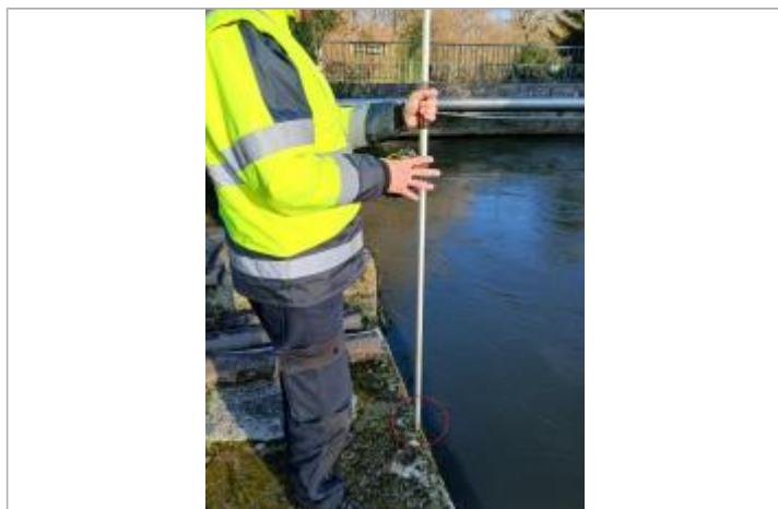
Laisse de crue à - 3 cm du haut de la margelle.
