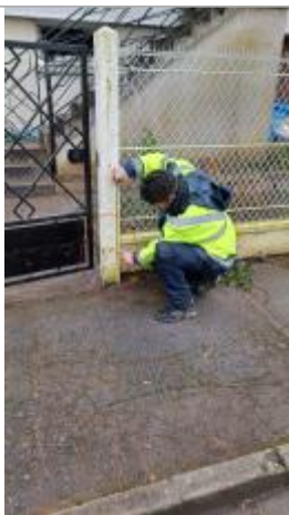
laisse de crue à 25 cm/sol.
