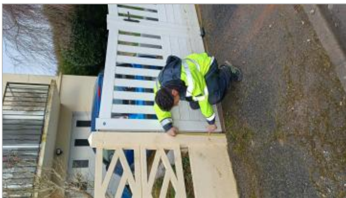
Laisse de crue à 22 cm/sol.
