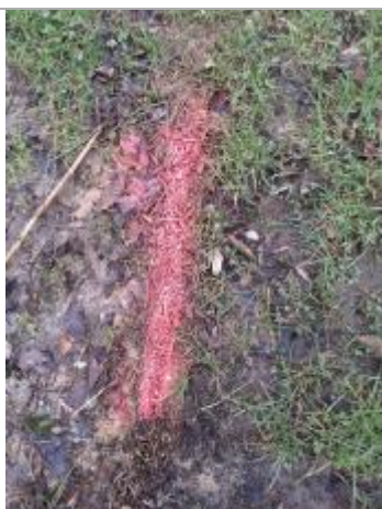
Marque de peinture au niveau d'une laisse de crue au sol (débris végétaux).
