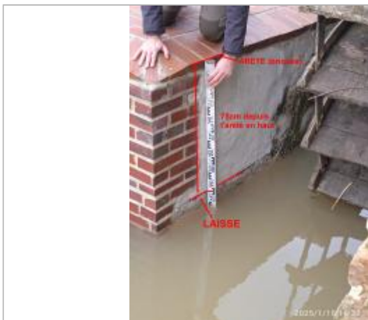
Laisse à 78cm depuis le haut du muret (arête en brique rouge) (source DDTM14)
