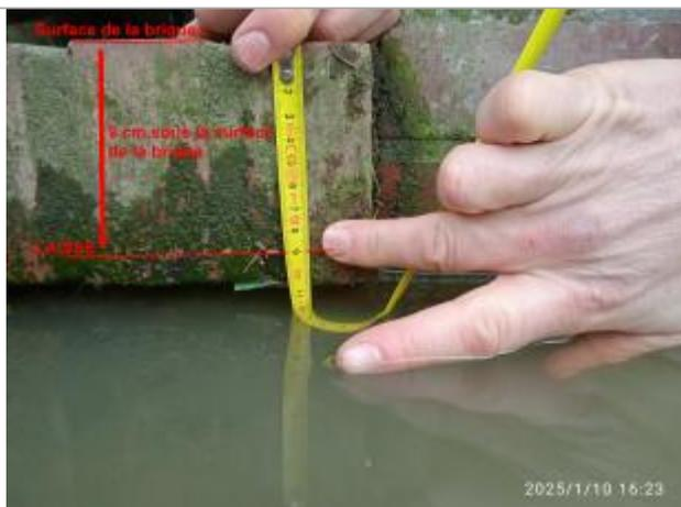
Laisse à 9 cm en dessous du haut de la bordure en brique entre le pont et le lavoir en rive droite (source DDTM14)
