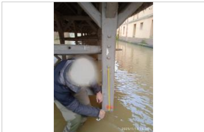
Marque peinte sur le poteau bois à 65 cm depuis le premier écrou/boulon au dessus (source DDTM14)
