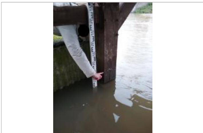
Débris végétaux à 30 cm du sol sur le poteau du lavoir/ Vue large (DDTM14)
