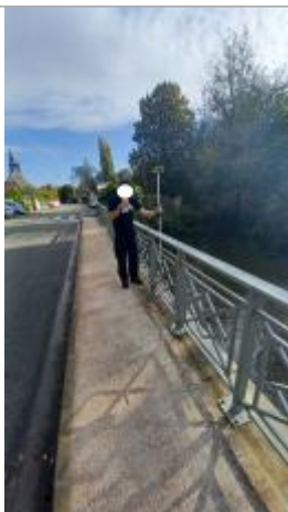
Nivellement du tablier du pont. (au milieu du pont coté amont)
