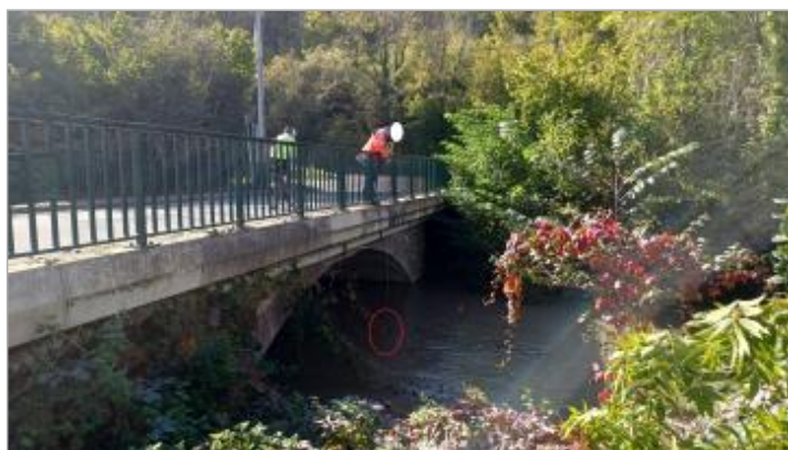
Le niveau de l'eau mesuré au centre du pont atteint - 253 cm sous le tablier du pont.
